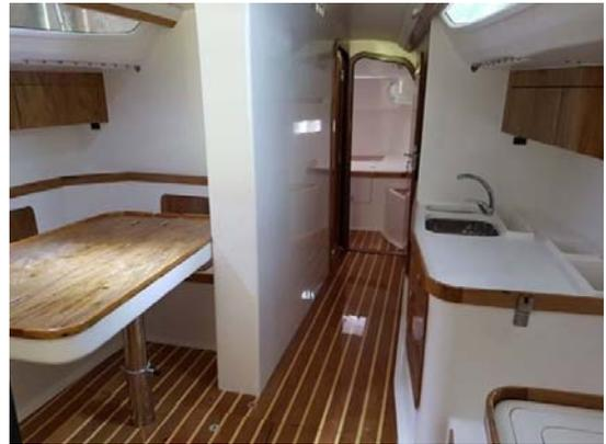
A foto a seguir demonstra o estilo de interior proposto, com maior parte construída em fibra de vidro, utilizando madeira apenas para dar requinte e contraste ao branco dos moveis em fibra de vidro.
